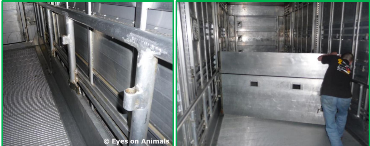
Truck waarbij schotten op verschillende posities geplaatst kunnen worden, zodat er compartimenten van verschillende groottes kunnen worden gemaakt.
