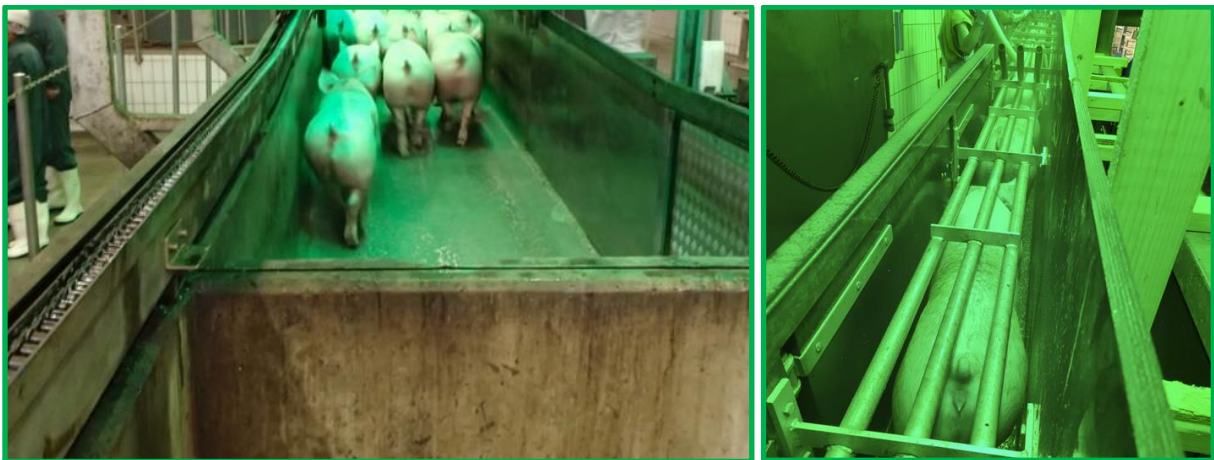
Door de gesloten en hoge wanden voorkom je dat varkens medewerkers naast de gang zien en worden afgeleid.
