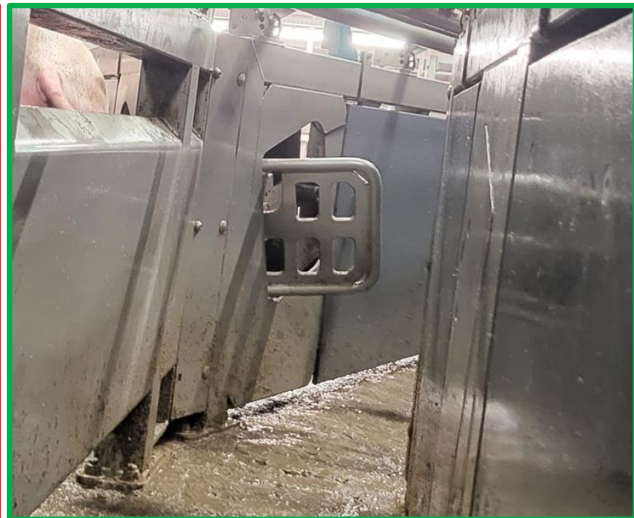
Bij Compaxo in Zevenaar zijn de oude klapdeurtjes (linkerfoto) vervangen door klapdeurtjes met gaten erin (rechterfoto). Deze deurtjes vormen minder een obstructie en maken dat de varkens elkaar door de deurtjes heen goed kunnen zien.
