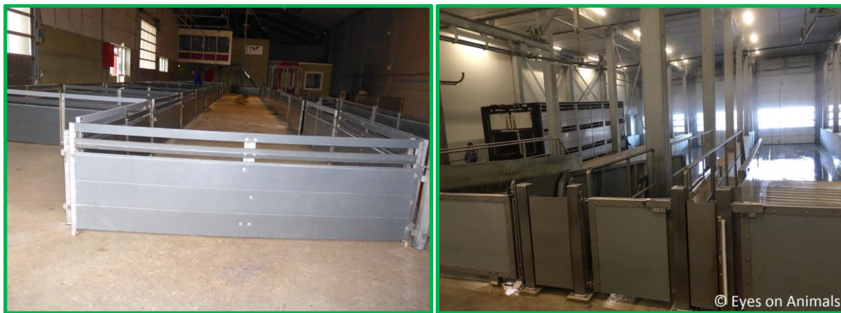
Kunststof hekken bij Meijer (links) en Westfort (rechts). Hierdoor is er minder omgevingsgeluid
