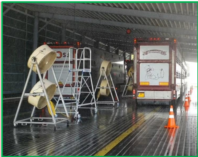
Links, oude situatie: ventilatoren staan te laag en bereiken niet alle laadniveaus. Rechts, nieuwe situatie; hoge verstelbare ventilatoren om alle laadniveaus in de truck te bereiken.
