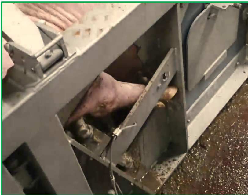
Varken zit vast met zijn/haar poot in een gat naast een klapdeurtje van de drijfgang
